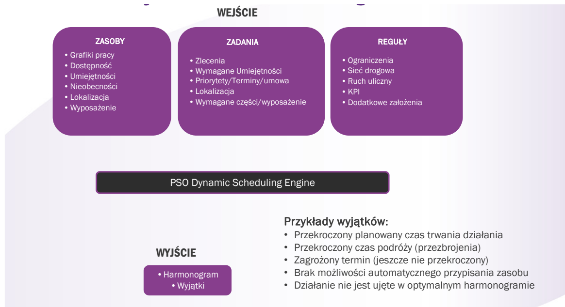
Rys. 2. Schemat blokowy modułu harmonogramowania [3]
