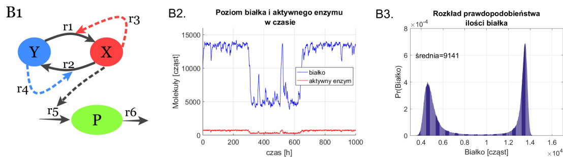
Rys. 4. Model produkcji białka z fluktuacjami enzymów - model B. (B1- schemat modelu; B2 - przebieg czasowy liczby cząsteczek białka; B3 - empiryczny rozkład prawdopodobieństwa liczby cząsteczek białka w danej chwili czasu)
