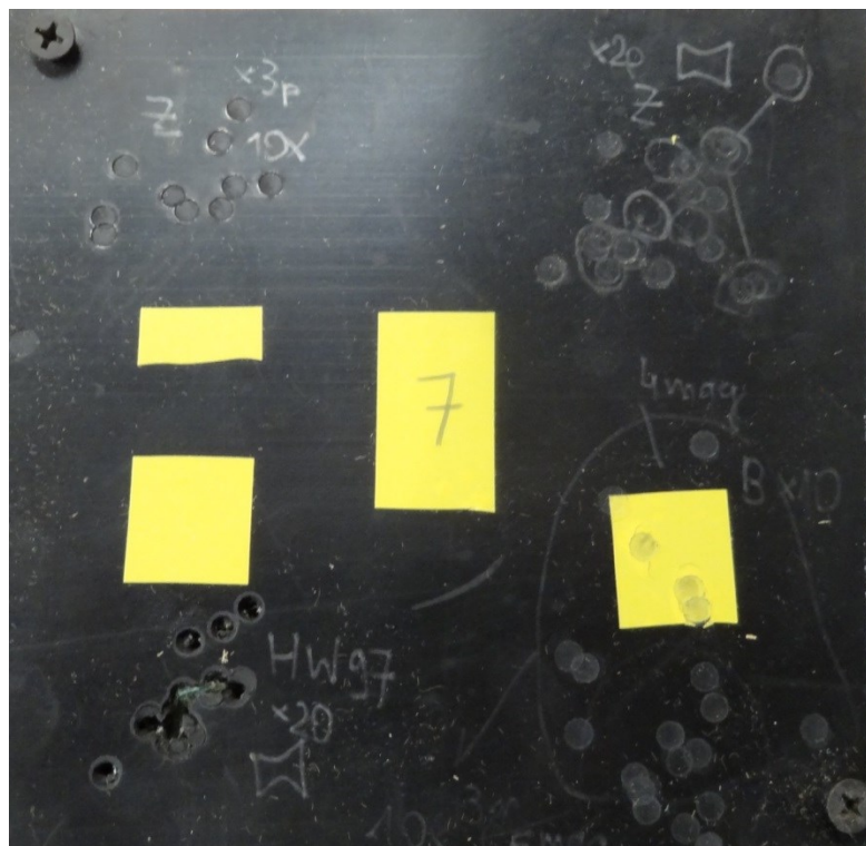
Rys. 3. Próbka 7 po testach; Z – trafienia pistoletem Zoraki (x2p – dwa pompowania, x3p – 3 pompowania); B – trafienia karabinkiem CX4 Storm; HW97 – trafienia karabinkiem HW97
