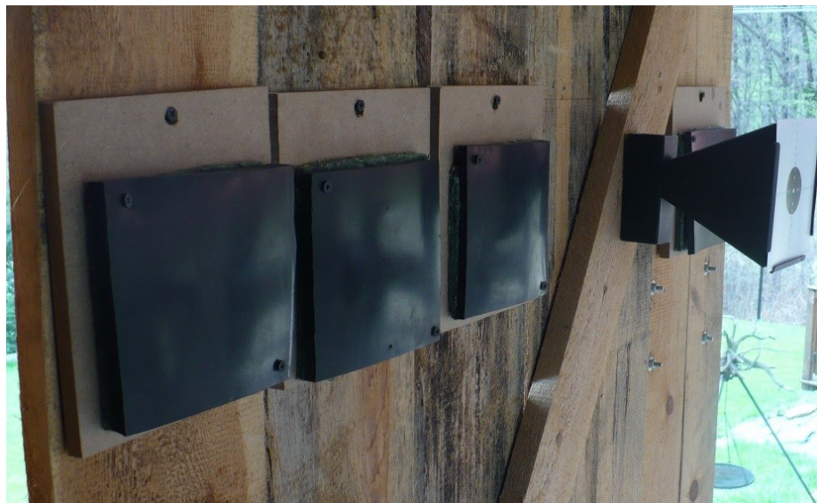
Rys. 2. Rozmieszczenie 3 próbek ekranów antyrykoszetowych na stanowisku testowym
