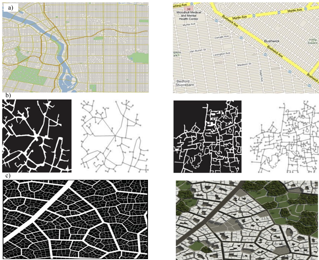
Rys. 1. Struktury komunikacyjne o topologii a): kratowej typu mesh [20], b): fraktalnej o strukturze drzewiastej – biały kształt na czarnym tle oznacza mapę tras komunikacyjnych, czarne krawędzie na białym tle obrazują model grafowy mapy tras [7] [22] b) i c)
