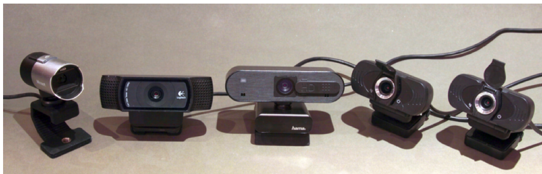
Rys. 3. Kamery wykorzystane w eksperymencie, od lewej: Microsoft LifeCam Studio (CAM-A), Logitech C920 (CAM-B), Hama C-600 Pro (CAM-C) oraz dwie kamery Xiaomi IMILAB CMSXJ22A (CAM-D i CAM-E).
