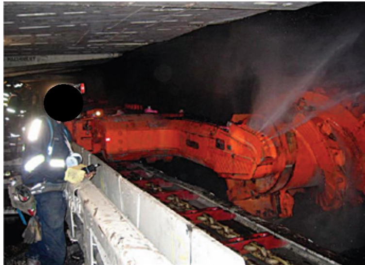
Rys. 3. Widok wyrobiska ścianowego z wyposażeniem w trakcie eksploatacji [2]
